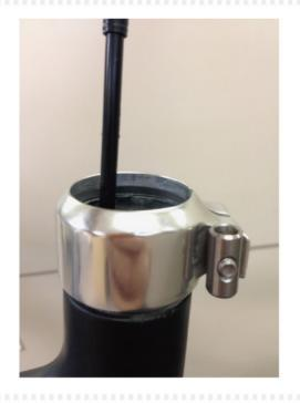
7) REMOVE SEAT POST FROM THE BIKE FRAME AND PULL THE HOUSING THROUGH THE SEAT TUBE.
