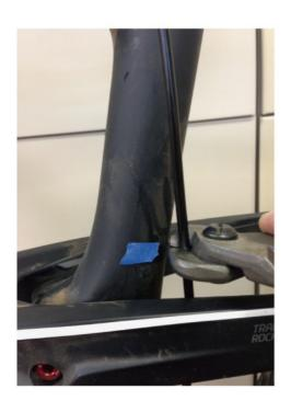
5) ROUTE THE CABLE HOUSING THROUGH THE FRAME AS YOU WILL DURING RIDING, AND UP THE OUTSIDE OF THE BICYCLE'S SEAT TUBE TO THE LOCATION WHERE THE TAPE IS ON THE FRAME. THIS IS YOUR OUT MARK, IMPORTANT NOTE: MAKE SURE YOU PULL THE SHIFTER CABLE OUT OF THE HOUSING CUTTING THE SHIFTER CABLE WILL BE TOO SHORT FOR PROPER INSTALLATION.
